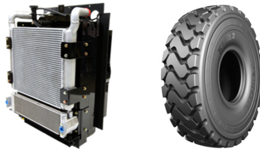
Figura 2: Módulo de Resfriamento (Esquerda) e Conjunto de Pneu e Roda (Direita)
