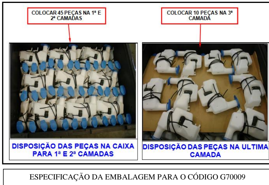
Figura 2: Plano de embalagem reservatório lavadores
